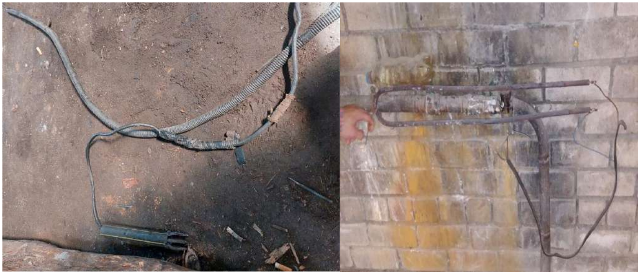
Применение самодельного электродержателя, обогревательного устройства (токоведущие части доступны для случайного прикосновения).
