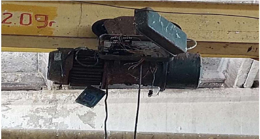
Не закрыты токоведущие части электротали.
